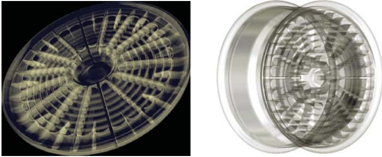
Abb. 4: Vorbild für technische Entwicklungen: a) leicht abstrahiertes CAD-Modell von Arachnoidiscus (J. Geisen, C. Hamm). b) Technische Umsetzung der Bauprinzipien von Arachnoidiscus in eine Ultra-leicht-PKW-Felge. Die sehr schlanken Speichen werden durch konzentrische Elemente stabilisiert (C. Hamm, U. Lüdemann)
